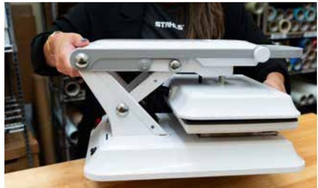
Um die Presse wieder in die Originalverpackung zu legen, heben Sie die Presse (in verriegelter Position) vorsichtig an, indem Sie das Ende des Hebelarms an der Rückseite und die Bodenplatte an der Vorderseite festhalten.
